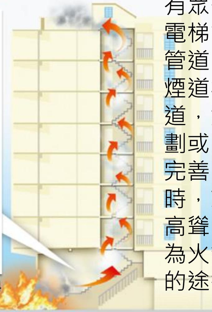
高層建築物內部有眾多的樓梯間、電梯管道、電纜管道、風道、排煙道等等垂直管道，如果防火區劃或防火處理不完善，火害發生時，就好像一座高聳的煙囪，成為火勢快速蔓延的途徑。
