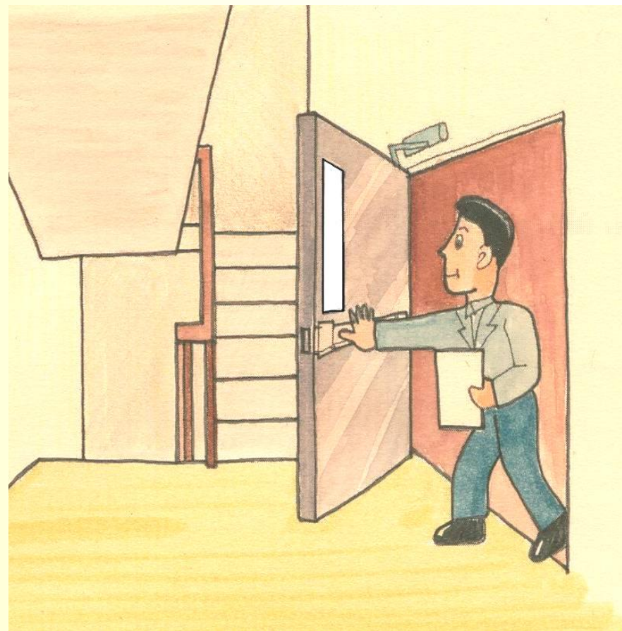
常時關閉式防火門
